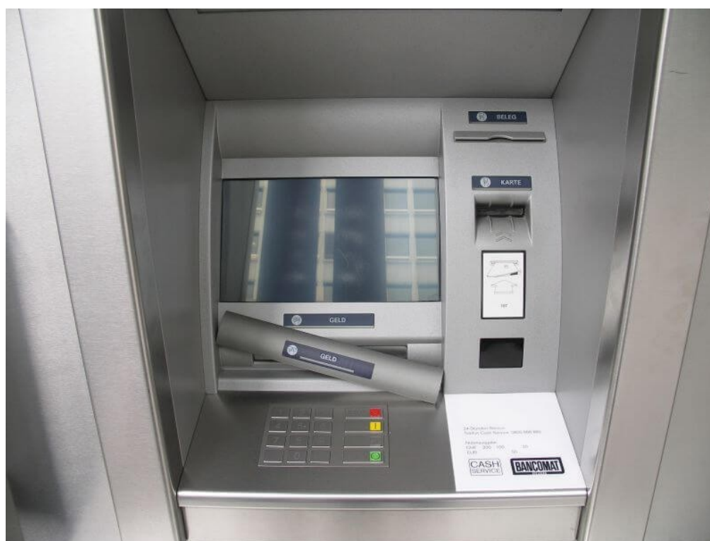
Камера в фальш-панели под экраном:
