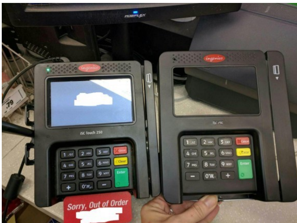
Терминал оплаты фирмы Ingenico (слева) и накладка-скиммер (справа), в точности имитирующая оригинал.
