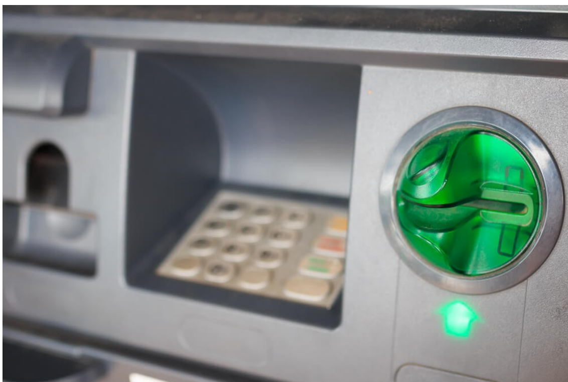
Антискиммер – защитная накладка на картоприемнике банкомата
