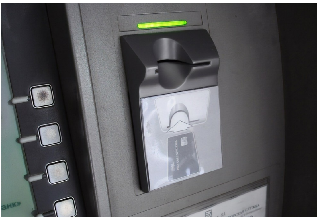
Установленный на картоприемник скиммер
