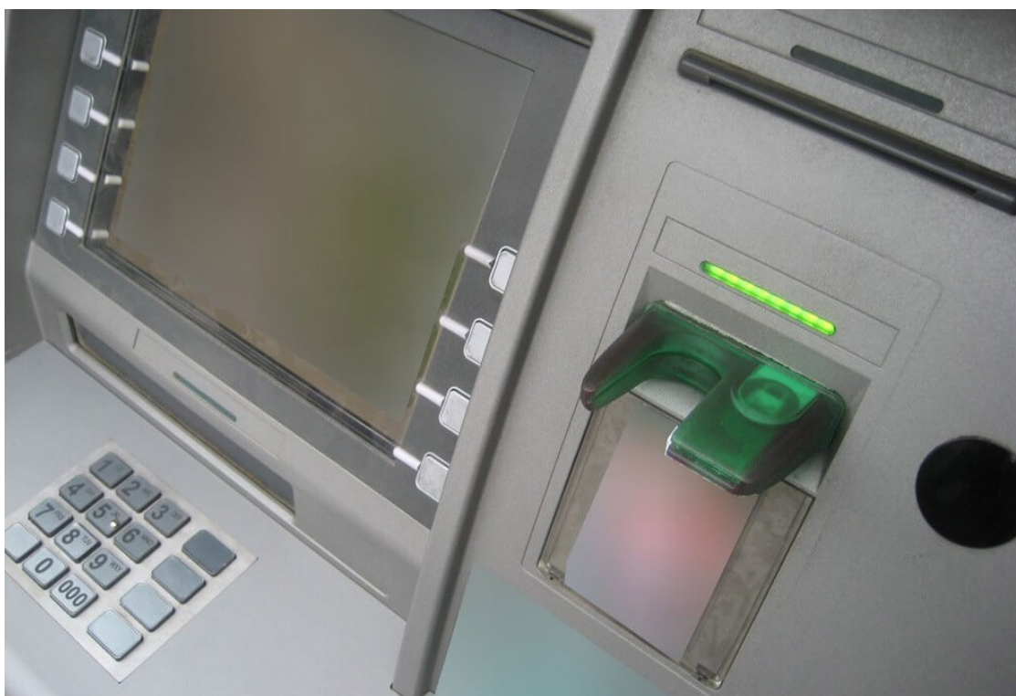
Лже-антискиммер: пластик затемнен и видны следы клея по контуру
