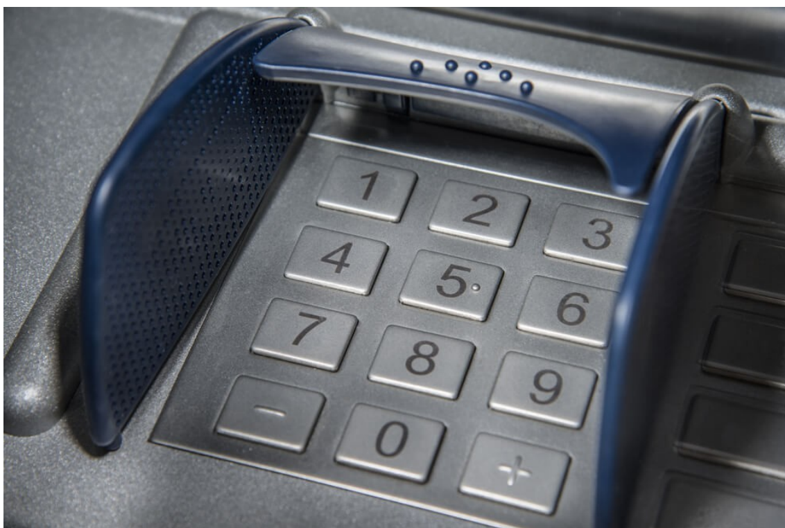
Клавиатура банкомата с защитными «крыльями»
